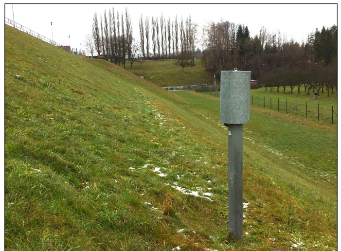
Obr.3 - Jednokanálový datalogger včetně antény je ukryt a plně funkční pod kovovým poklopem vrtu
